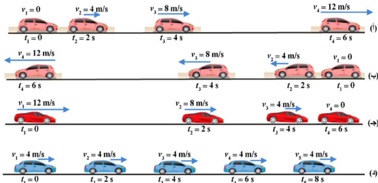
**في الشكل (أ):** تتحرك السيارة يميناً، أي تجاه محور  $+x$ ، ملاحظاً تزايد سرعتها بمقدار ثابت خلال مدد زمنية متساوية؛ أي أنها تتسرع. وأحسب تسرعاً لها بين أي مدتین زمنيتین:
