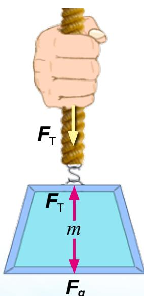
قوة الشد هي قوة سحب تؤثُّر في جسم عن طريق سلك أو خيط أو حبل، رمزها ( $F_T$ )، وتؤثُّر في اتجاه طول الخيط أو الحبل أو السلك. ولتبسيط عند التعامل مع المسائل التي تتضمن خيوطاً وحبلاً وأسلاكاً، فإننا سنهمل كلَّها، ونعدُّها غير قابلة للاستطالة.
