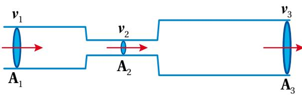
$$A_1 v_1 = A_2 v_2 = A_3 v_3$$
