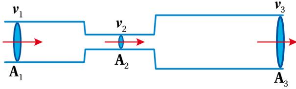
$$A_1 v_1 = A_2 v_2 = A_3 v_3$$
