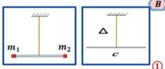
$$\frac{T_0}{T_0} = \frac{2\pi\sqrt{\frac{I_{\Delta/\text{ساق}}}{K}}}{2\pi\sqrt{\frac{I_{\Delta/\text{جملة}}}{K}}} \quad \Rightarrow \quad \frac{T_0}{T_0} = \sqrt{\frac{I_{\Delta/\text{ساق}}}{I_{\Delta/\text{جملة}}}}$$
