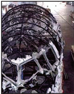
شكل (٣-٧). محاولة تجميع حطام مقدمة الطائرة للوصول إلى أي أدلة ممكنة
