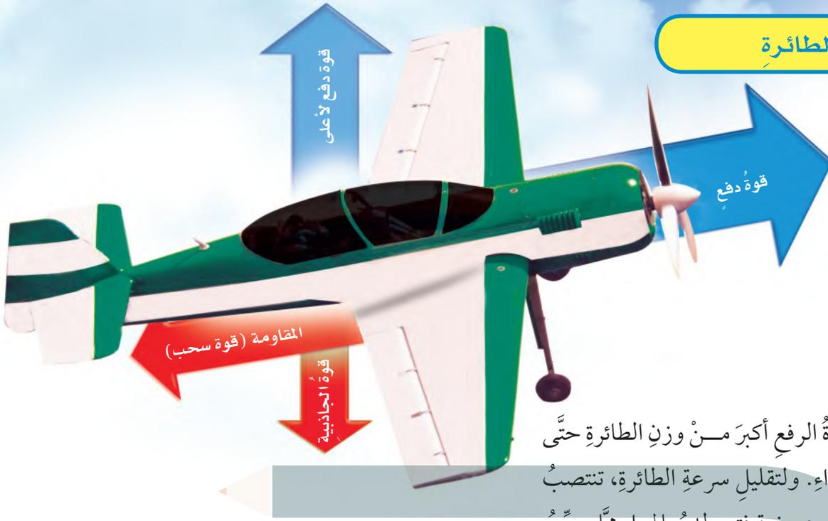
ويجب أن تكون قوة الرفع أكبر من وزن الطائرة حتى ترتفع الطائرة في الهواء. ولتقليل سرعة الطائرة، تنتصب قطع فلزية مستوية وعريضة فتصطدم بالهواء مما يسبب إبطاء حركة الطائرة. وتسمى هذه القوى قوى المقاومة، وهي قوى سحب تعيق حركة الطائرة.
