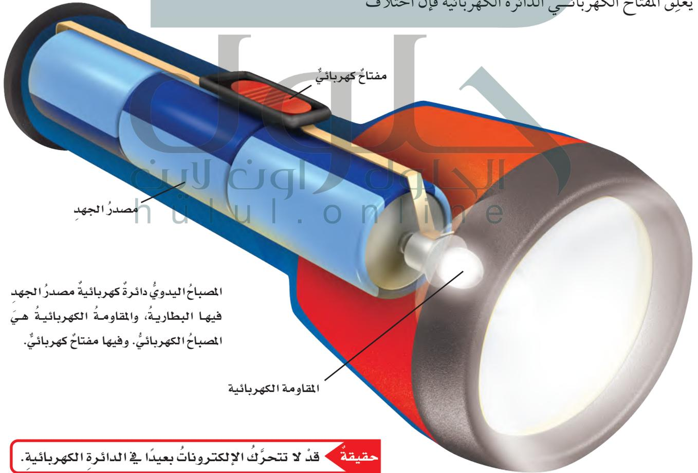
المصباح اليدوي دائرة كهربائية مصدر الجهد فيها البطارية، والمقاومة الكهربائية هي المصباح الكهربائي. وفيها مفتاح كهربائي.
