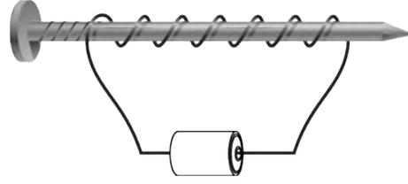
كيفَ يمكنُ زيادةُ قوةِ جذبِ المغناطيسِ الكهربائيِّ؟
