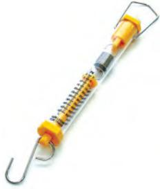
١ لقياس الوزن نستخدم الميزان النابضيّ (الزنبركيّ). الوزن مقدار قوة جذب الأرض للجسم، ويقاس وزن الجسم بوحدة النيوتن.
