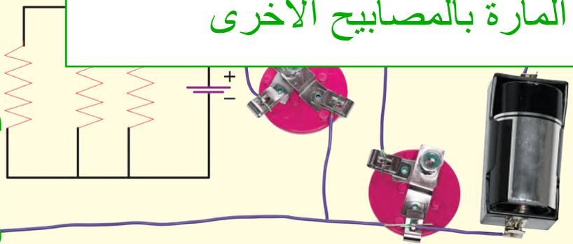
يسري التيار الكهربائي في الدائرة الموصولة على التوازي في أكثر من مسار.
