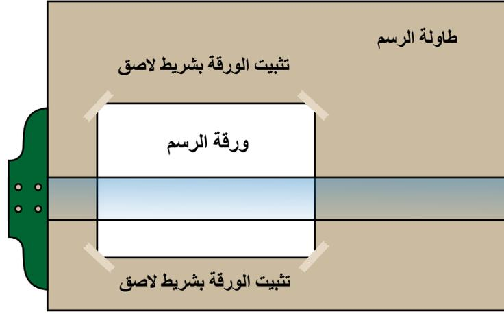
الشكل (10-1/أ): طريقة تثبيت ورقة الرسم.
