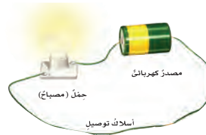
▲ أجزاء الدائرة الكهربائية.
