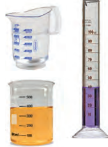
▲ تقاس حجوم السوائل باستخدام المخبر المدرج أو الكأس المدرج.
