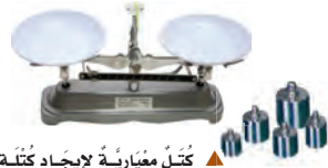
كتل معيارية لإيجاد كتلة المادة باستعمال الميزان ذي الكفتين.
