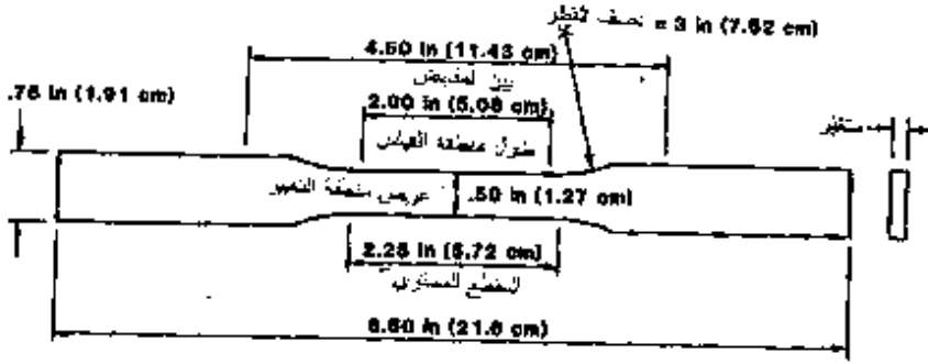
الشكل 21-2 عينة شد وفق المواصفة ASTM D 638
