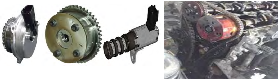
الشكل (٣-٤٣): التوقيت المتغير للصمامات.
