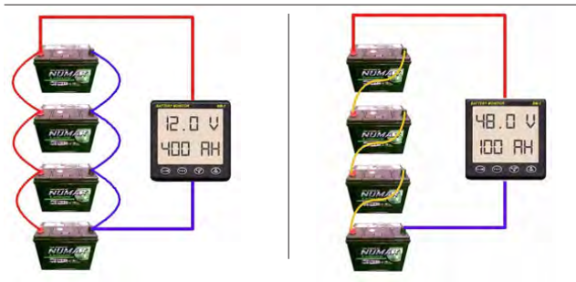
الشكل (٢-٧): طرائق توصيل المراكم.
