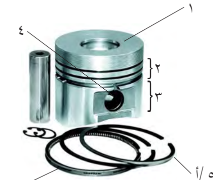
الشكل (٣-٥): المكبس والرنجات ومسمار المكبس والدسر.
