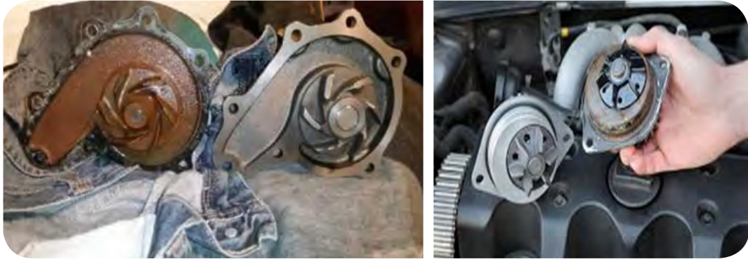
الشكل (٤-٣١): مضخة التبريد.
