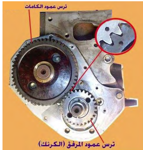
الشكل (٣-٤٤): التعشيق المباشر لمسننات عمود المرفق وعمود الكامات.
