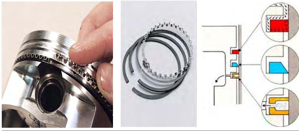
الشكل (٣-٧): حلقات المكبس وتركيبها.
