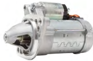
الشكل (٢-٤٦): بادئ حركة ذو نظام تعشيق من نوع بندكس.
