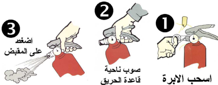
الشكل (4): خطوات استخدام طفاية الحريق
