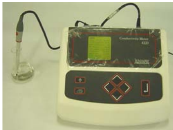
جهاز قياس التوصيلية
