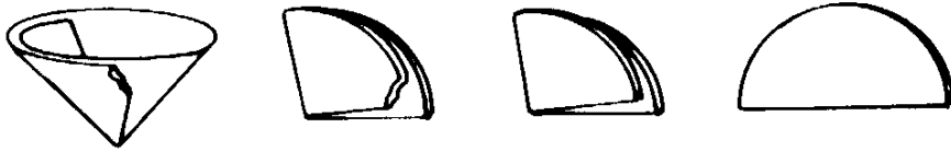
الشكل (2. ب): طريقة ثني ورق ترشيح (زاوية غير قائمة للقطع المشية)
