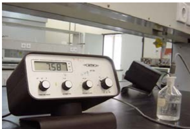
جهاز قياس الرقم الهيدروجيني
