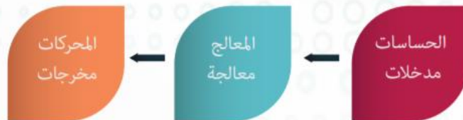
شكل (٤-٦): يوضح العلاقة بين مكونات الروبوت
