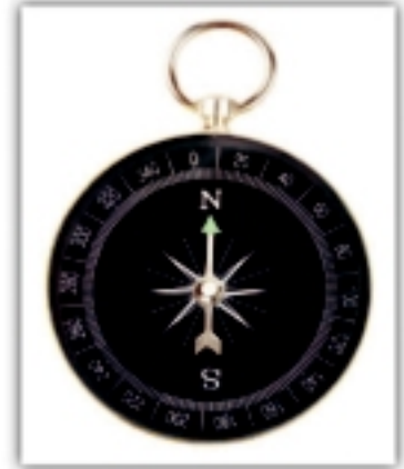
شكل (٢١): تحتوي البوصلة على مغناطيس صغير خفيف حر الحركة.
