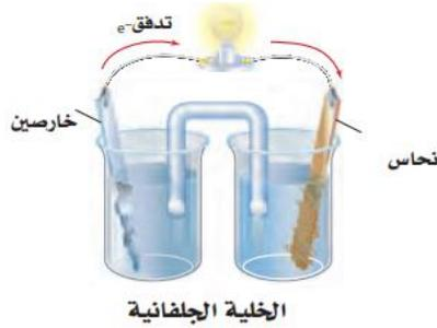
تعمل أكسدة الخارصين في هذه الخلية على تزويد المصباح بالالكترونات لإضاءته واختزال أيونات النحاس، ويستمر التفاعل التلقائي حتى يستهلك الخارصين.
