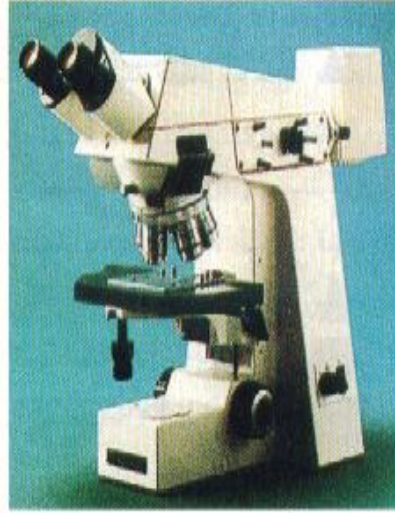
ميكروسكوب حديث ذو عدستين عينية . ويلاحظ وجود برج دوار يسمح باختيار العدسات الشيئية المناسبة .
