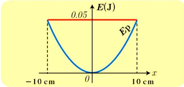
المعطيات:  $m = 4 \times 10^{-1} \text{ kg}$ ,  $E_{tot} = 5 \times 10^{-2} \text{ J}$ ,  $X_{max} = 10^{-1} \text{ m}$
