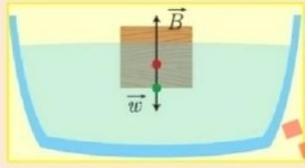
وضع مكعب من الخشب كتلته  $2\text{kg}$  فوق حوض مملوء بالماء فيتوازن المكعب تحت تأثير قوة ثقله  $w$  ، وقوة دافعة أرخميدس  $B$  كما هو مبين في الشكل ، والمطلوب : انطلاقاً من شرط التوازن الإنسحابي ، احسب شدة القوة  $B$  . بفرض أن تسارع الجاذبية الأرضية  $g = 10\text{m.s}^{-2}$
