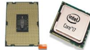
شكل (٤-٦) : المعالج (Core i7) ، مع إيضاح صورة سطح وظاهر المعالج
