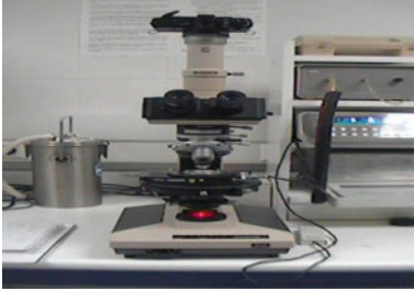
شكل (٦-٦) المجاهر الحرارية المرتبطة بجهاز جريم
