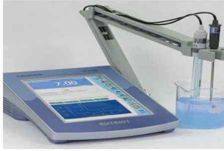
شكل (٧-٤) يوضح جهاز مقياس الأس الهيدروجيني
