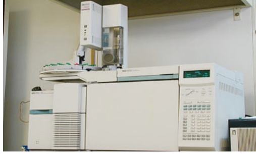
شكل (٦-٣) جهاز كروماتوجرافيا الغاز مطياف الكتلة GC-MS
