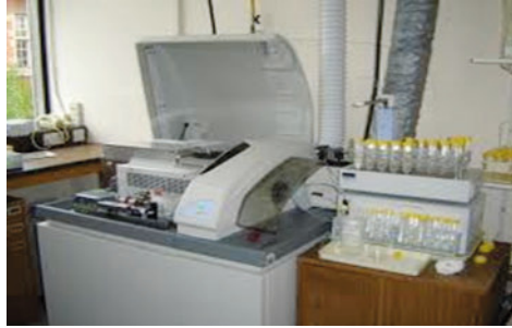
شكل (٧-٥) جهاز الحث البلازمي المقترن بمطياف الكتلة (MS-ICP)
