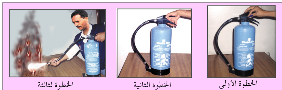
شكل (٢) خطوات استخدام طفاية الحريق
