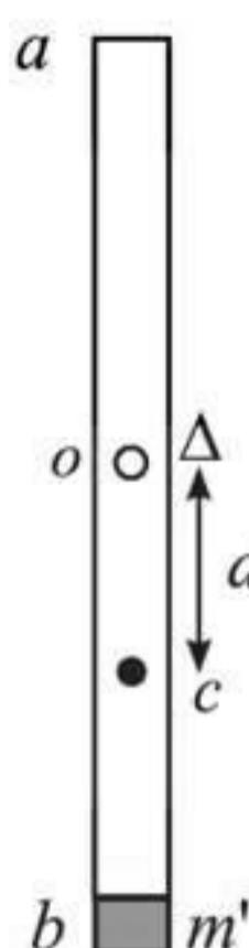
$$T_0 = 2\pi \sqrt{\frac{I_\Delta}{mgd}} \quad (1) \text{ حساب الدور الخاص:}$$
