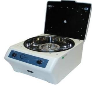
يُستخدم جهاز الطرد المركزي لفصل عينات البول والبراز وذلك للحصول على الراسب لاستخدامه في الفحص المجهرى.
