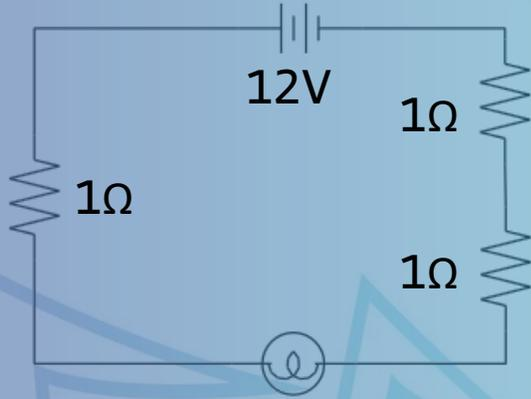
قام طالب بوصل مصباح بثلاث مقاوومات كما في الشكل، فقال له صديقه أنه يمكنه ربط المصباح الكهربائي بمقاومة واحدة ليحصل على نفس السطوع بشرط أن تكون قيمة المقاومة:
