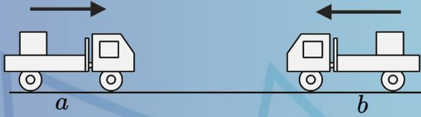
في الشكل المجاور، سيارتان متجهتان نحو بعضهما بنفس السرعة، إذا أطلق قائد سيارة (a) المنبه بتردد (450Hz)، فما التردد الذي سيسمعه قائد السيارة (b) بوحدة (Hz)؟ وعلماً أن سرعة الصوت = 343m/s
