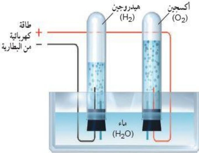
من خلال الشكل المقابل أكتب معادلة التحلل الكهربائي للماء ؟
