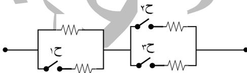
٦٧- إذا كانت المقاومات المتصلة في الشكل المجاور متساوية. يمكن الحصول على أكبر مقاومة كهربائية بإغلاق :
