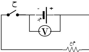
٦٥- في الشكل المجاور إذا علمت أن قراءة الفولتمتر قبل إغلاق المفتاح (ح) تساوي (س) فولت ، وكان الهبوط في الجهد بعد إغلاق المفتاح (ح) يساوي (ص) فولت ، فإن قراءة الفولتمتر عندئذ بوحدة الفولت تساوي :
