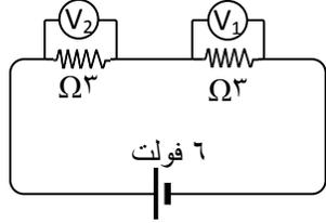
٣٧- في الدارة المجاورة، إذا كانت البطارية مهملة المقاومة الداخلية، وكانت قراءة الفولتميتر  $(V_1)$  تساوي  $(2)$  فولت، فإن قراءة الفولتميتر  $(V_2)$  تساوي:
