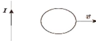
**الجواب:** عند توقف الملف الدائري عن الحركة تثبت شدة الحقل المغناطيسي المحرض المتولد عن التيار المار في السلك المستقيم وبالتالي يصبح تغير التدفق المغناطيسي المحرض معدوم في الملف الدائري فتتعدم القوة المحركة الكهربائية المتحرضة وتنعدم شدة التيار المتحرض في الملف.
