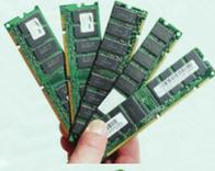
٦ ذاكرة القراءة العشوائية (Random Access Memory (RAM): ويتم فيها تخزين البيانات أو التعليمات تخزيناً مؤقتاً، ويمكن تغييرها أو الإضافة إليها، وتفقد محتوياتها عند فصل التيار الكهربائي، وكلما زاد حجم الذاكرة زادت سرعة الحاسب، ويظهر في الشكل (٧-٢) أشكال من ذاكرة القراءة العشوائية.
