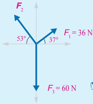
يمثل الشكل (8) مخطط الجسم الحُرِّ لدمية متزنة، يؤثر فيها ثلاث قوى في الاتجاهات المبينة في الشكل. أجد مقدار القوة  $(F_2)$ .
