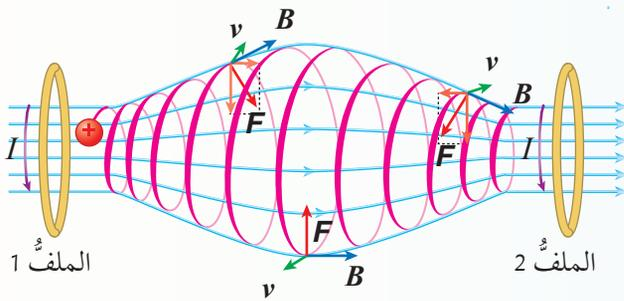
تقنية يُستخدم فيها ملفان كهربائيان لتوليد مجال مغناطيسي مُتغيّر المقدار والاتجاه؛ لاحتواء جسيمات مشحونة كهربائيًا، وذات طاقة عالية جدًا مثل البلازما. وبحسب الشكل المجاور، فإن الملفين الكهربائيين والمجال المغناطيسي الناتج منهما يُشبهون الزجاج، فكيف يمكن احتواء مادة البلازما باستخدام هذه التقنية؟
