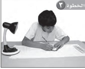
٣ أجربُ. أصلُ المصباحِ الكهربائيِّ بالكهرباءِ، وأضغظُ مفتاحَ التشغيلِ. وأتركُ الضوءَ مسلطاً على مقياسِ الحرارةِ مدةَ خمسِ دقائقَ. وأدوّنُ درجةَ الحرارةِ، ثمَّ أطفئُ المصباحَ، وأفصلُهُ عن مصدرِ الكهرباءِ ثمَّ أتركُهُ على الطاولةِ حتّى يبردَ، وتصلَ درجةُ حرارةِ مقياسِ الحرارةِ إلى الدرجةِ التي بُدئتُ بها التجربةُ.
