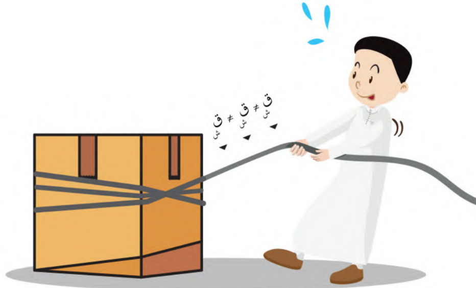
الشكل ١٥ عند عدم إهمال كتلة الحبل فإن قوة الشد غير متساوية في أجزاء الحبل.
