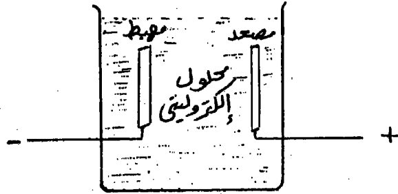
شكل (٩ - ١) خلية تحليل كهربى
