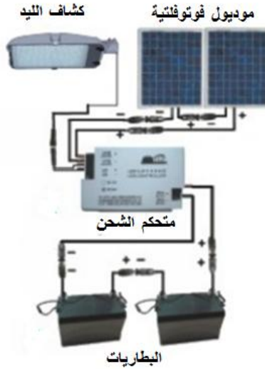
شكل (٤) التوصيلات والقطبية بين مكونات عمود إنارة يعمل بالطاقة الشمسية
