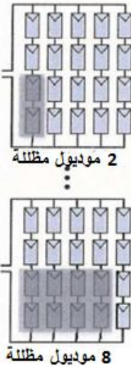
شكل (١٧) خصائص منحنيات التيار والقدرة عند تعرض
