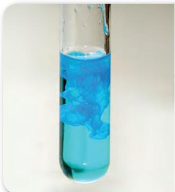
الشكل 17-4 عندما يضاف هيدروكسيد الصوديوم إلى محلول كلوريد النحاس II، تتبادل أيونات  $Cl^-$  و  $OH^-$  موقعيهما، وينتج عن التفاعل كلوريد الصوديوم الذي يبقى ذائباً في المحلول، وهيدروكسيد النحاس II الذي يترسب في صورة مادة صلبة زرقاء اللون.
