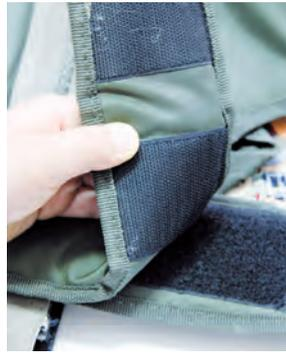
تستعمل ألياف النايلون في صناعة أشرطة التثبيت.
