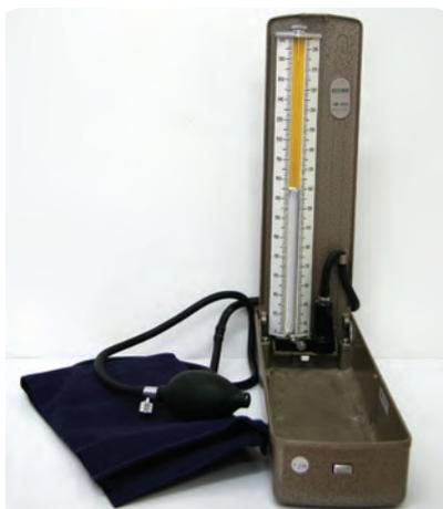
جهاز قياس ضغط الدم (زئبق - سائل)
