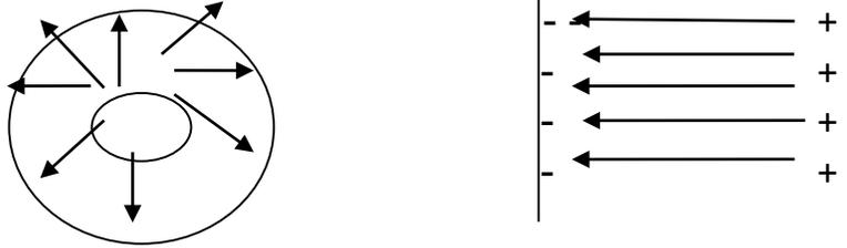
تنطلق خطوط المجال من الشحنات الموجبة وتنتهي على الشحنات السالبة، و تنحصر بين السطحين سواء أكان المجال متجانسا (ثابتا) أم متغيرا. وتسمى المنطقة في الفراغ والتي تنحصر فيها خطوط المجال الكهربائي بالمكثف الكهربائي ويرمز له بالرمز "C".
