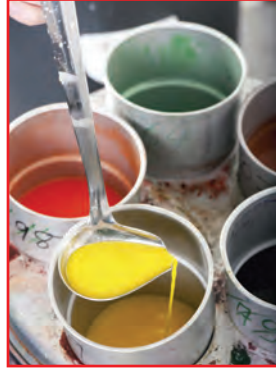
▲ يُصهر الشمع حتى يصبح سائلاً، ثم يُصب في قالب كبير.
