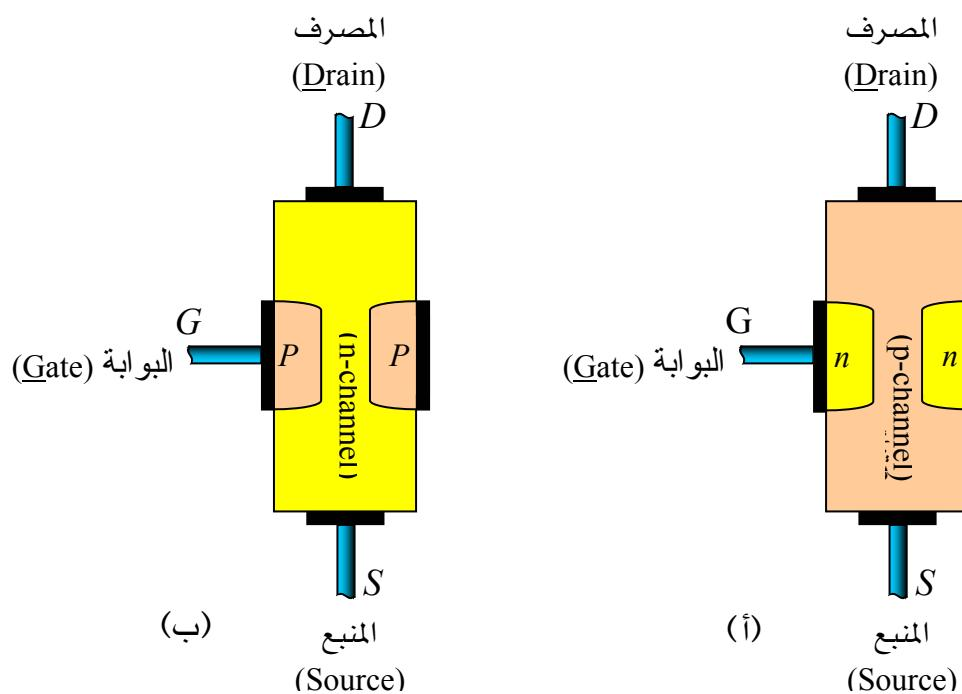
شكل (٧-٢) التركيب الأساسي لنوعي ترانزستور تأثير المجال ذو الوصلة (JFET)
