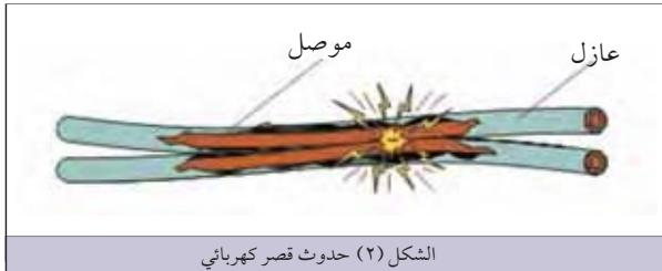
هائل يتوج حرارة مرتفعة قد تؤدي إلى اتلاف بعض أجزاء الدارة الكهربائية، نقول بأنه حصل قصرًا (Short Circuit) في الدارة. يحدث القصر في الدارة الكهربائية من أسباب عدة، كسوء عزل الوصلات أو توصيل خاطئ في الأسلاك كما مبين في الشكل (٢).
