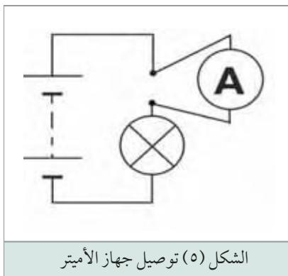
تقاس شدة التيار في الدارات الكهربائية بجهاز خاص يدعى الأميتر ويرمز له بدائرة بداخلها الحرف (A). ومن الجدير بالذكر أن جهاز قياس شدة التيار (الأميتر)، يجب أن يوصل على التوالي في الدارة المراد قياس شدة التيار فيها كما في الشكل (٥).
