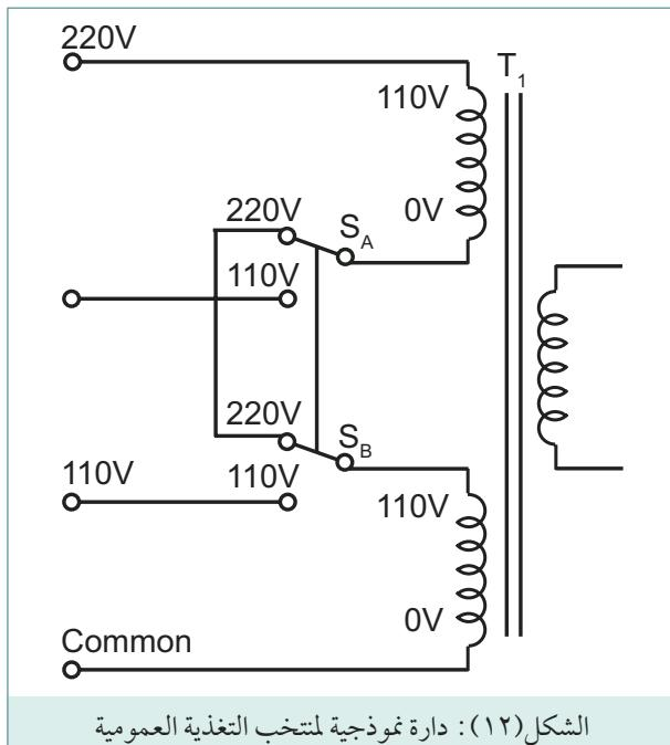
بعض محولات القدرة متعددة الإغراض تزود بملفان ابتدائيان يسمحان بالاشغال على تغذية (110 فولت) أو (220 فولت)، والشكل (١٢) يبين دارة نموذجية لمنتخب فولتية التغذية العمومية مبنية على أساس مفتاح ثنائي القطب ثنائي الرمية  $S_A$ . ويجب التنويه أن الاستخدام الخاطئ لمفتاح انتخاب فولتية التغذية العمومية يؤدي بالعادة إلى حرق الملف الابتدائي للمحول ووحدة التغذية.
