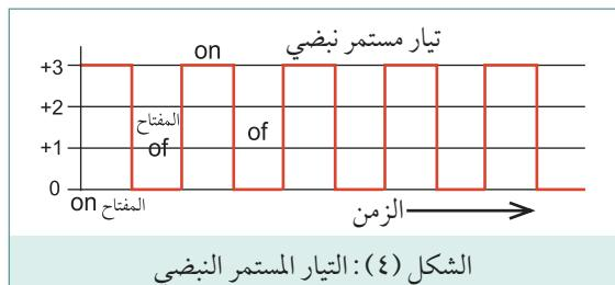
إما إذا استخدمنا مفتاح لقطع التيار عبر المقاومة بشكل منتظم، فسوف نحصل على موجة تيار مستمر نبضية . ، كما هو مبين في الشكل (٤)
