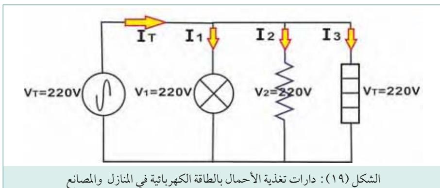
الشكل (١٩) : دارات تغذية الأحمال بالطاقة الكهربائية في المنازل والمصانع
