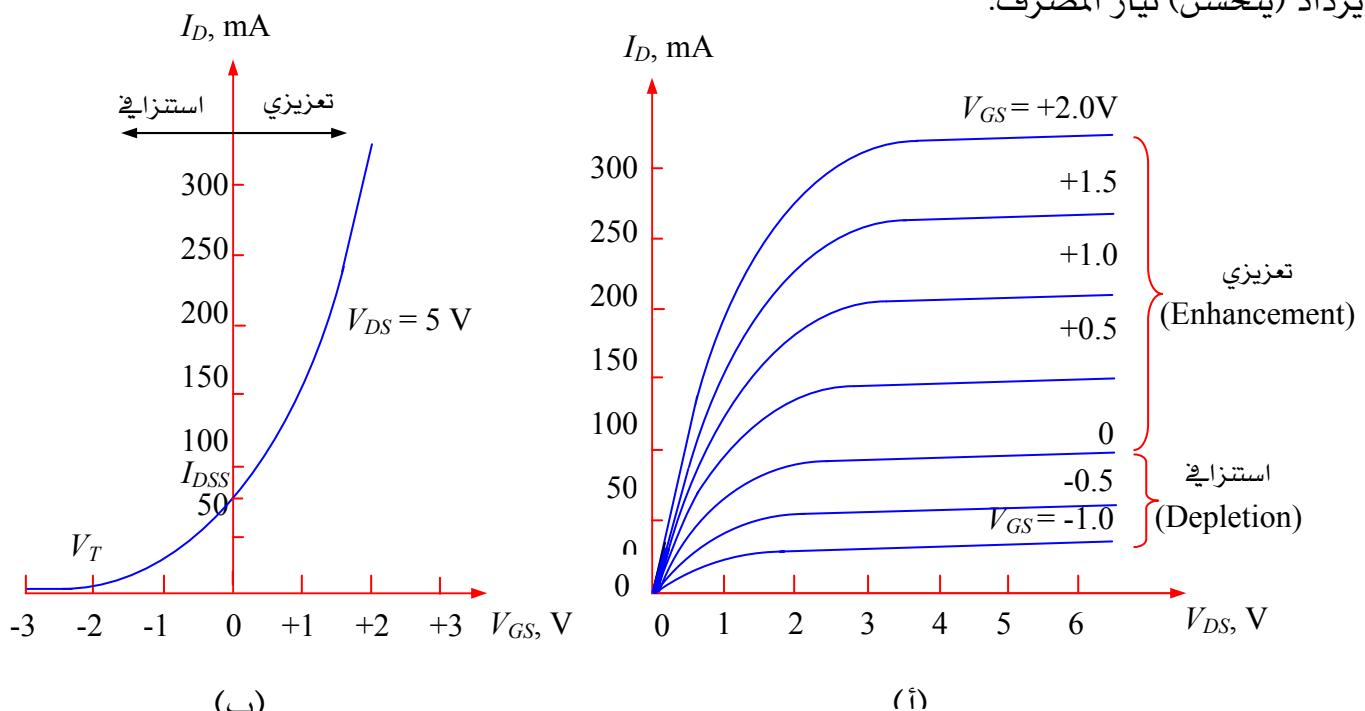
شكل (٧ - ١٢) منحنيات خواص النوع الاستزافي لترانزستور MOSFET ذو القناة n- (أ) خواص المصرف أو الخرج (Drain or Output characteristics)
