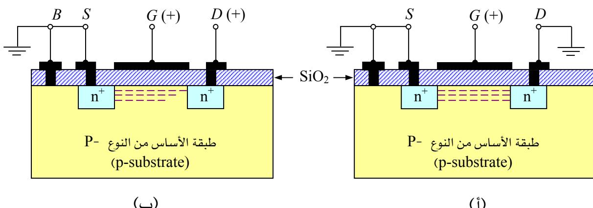
شكل (٧ - ٩) القناة التأثيرية لنوع التعزيزي لترانزستور MOSFET ذو القناة  $n^-$
