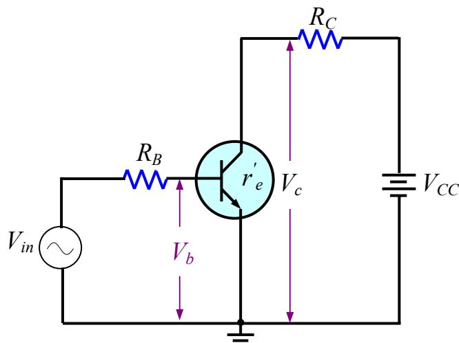
شكل (٣-٥) الدائرة المكافئة في حالة التيار المتردد.
