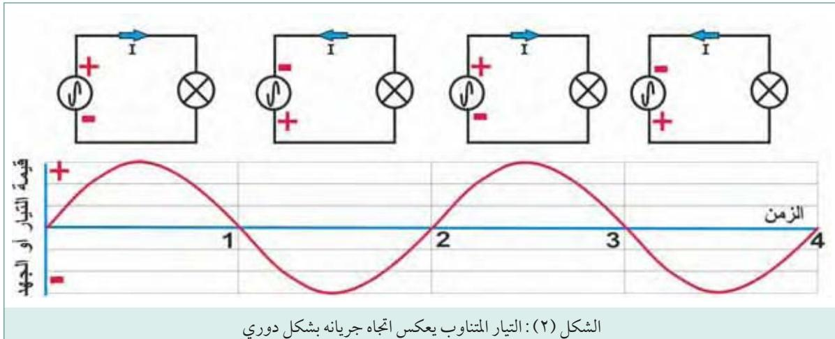
الشكل (٢): التيار المتناوب يعكس اتجاه جريانه بشكل دوري
