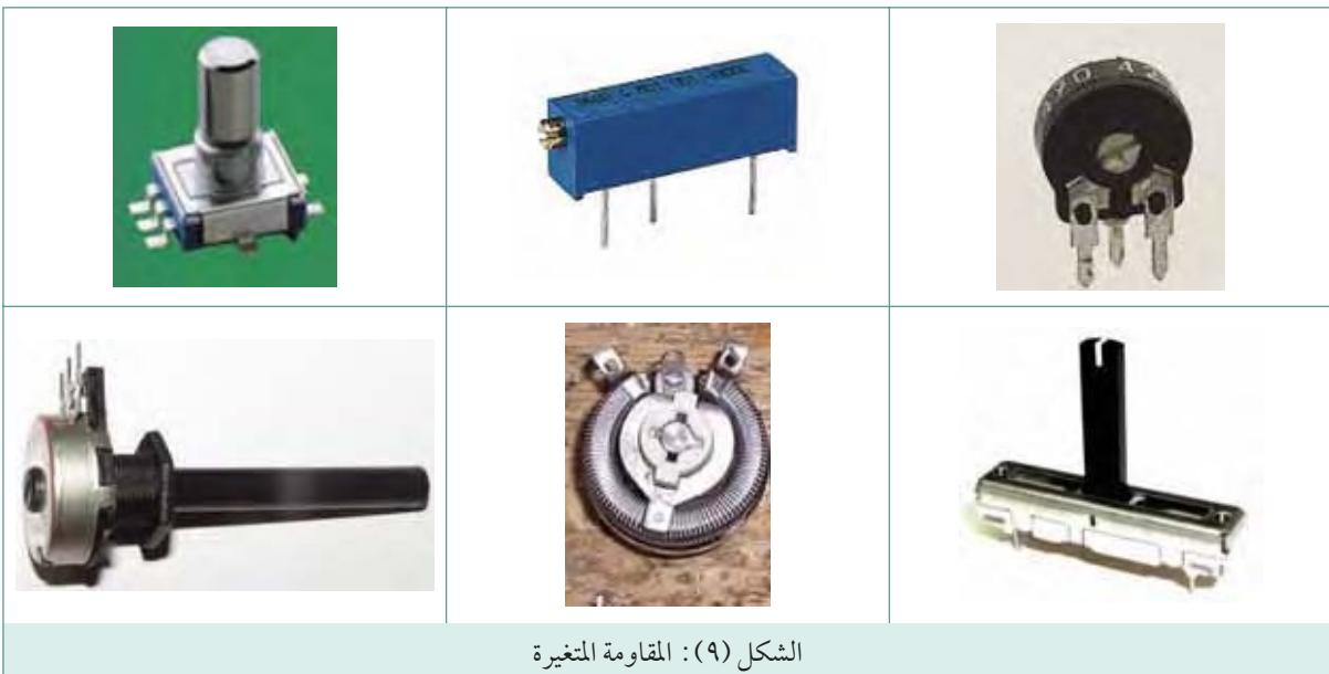
يطلق على المقاومة المتغيرة أيضاً اسم مقياس الجهد (Potentiometer). مقياس الجهد هو مقسم حيث تتحدد قيمة جهد الخرج ( $V_{OUT}$ ) بكل من جهد المدخل ( $V_{IN}$ ) وكذلك حركة المترافق على مسار الكربون، لاحظ الشكل (١٠). وتتحدد قيمة جهد المخرج في حالة اللاحمل بما يلي :
