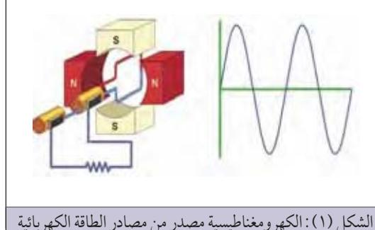
الشكل (١): الكهرومغناطيسي مصدر من مصادر الطاقة الكهربائية
