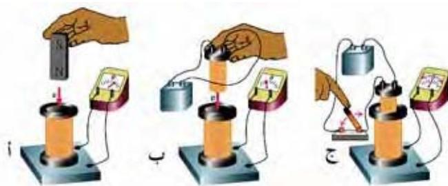
الشكل (١٨) : مبدأ توليد القوة الدافعة الكهربائية
