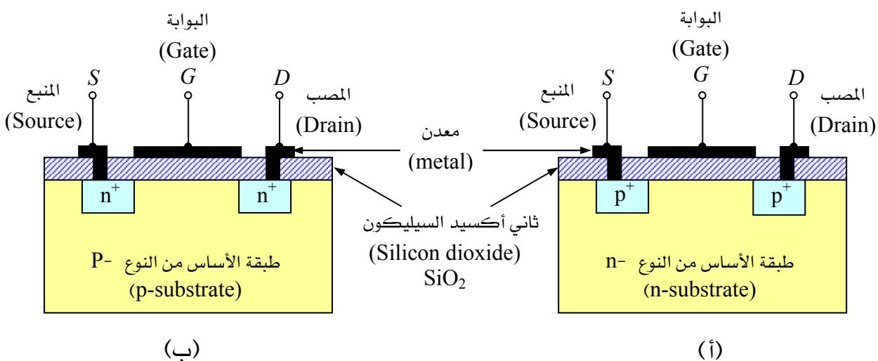
شكل (٧ - ٨) تركيب النوع التعزيزى لترانزستور MOSFET
