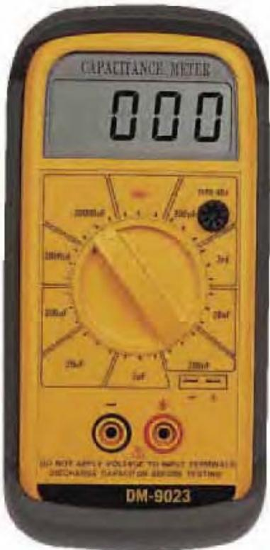
الشكل (١٣): جهاز قياس السعة الرقمي.
