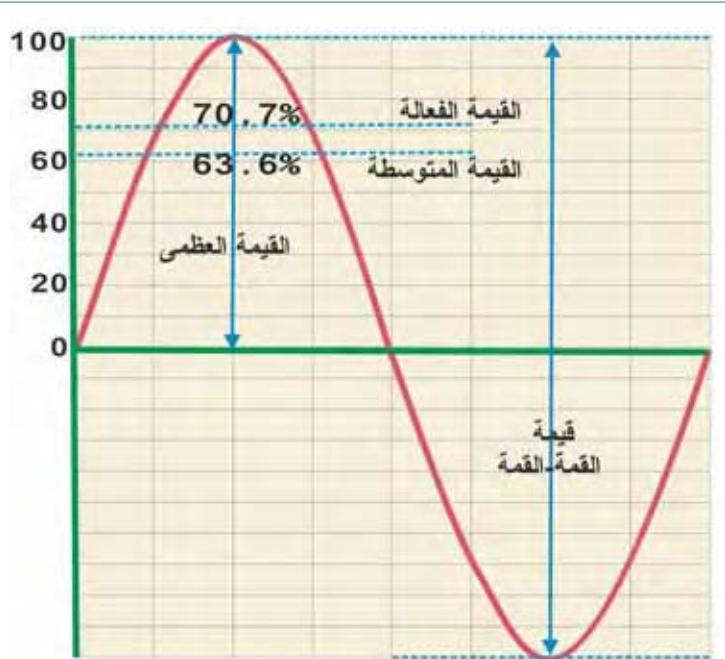
الشكل (١٥) : قياسات الموجة الجيبية للجهد أو التيار
