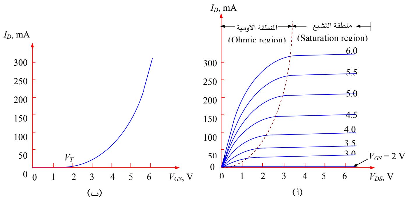
شكل (٧ - ١٠ - ١) منحنيات خواص النوع التعزيزي لترانزستور MOSFET ذو القناة -n
