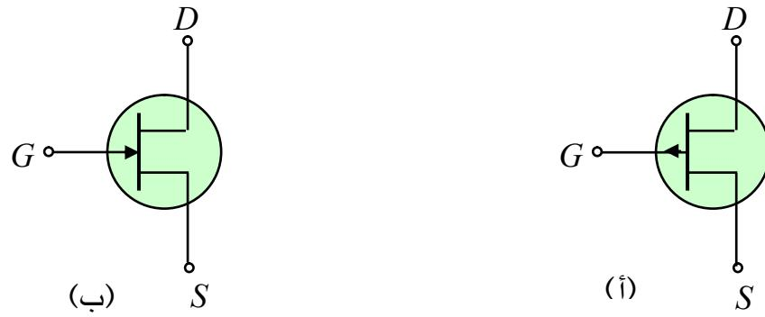
شكل (٧ - ٣) الرمز التمثيلي لنوعي ترانزستور تأثير المجال ذو الوصلة (JFET)
