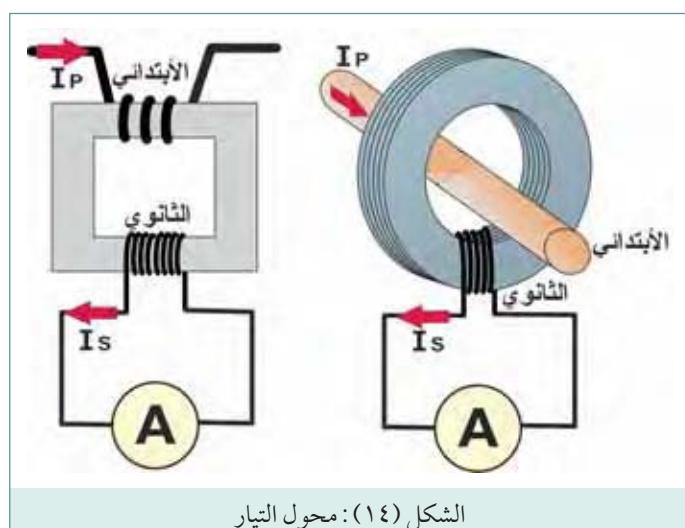
يستخدم محوّل التيار مع أجهزة قياس التيار المتناوب (الأومميتر) بهدف خفض قيمة التيار المتناوب المراد قياسه إلى قيمة مناسبة يسهل قياسها ، كما يستخدم لعزل جهاز القياس عن أسلاك الفولتية العالية .
