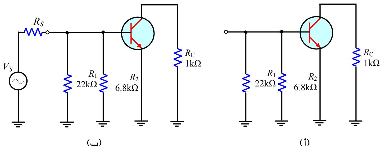
شكل (٦ - ١٥) الدائرة المكافئة في حالة التيار المتردد.
