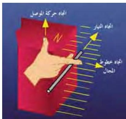
الشكل (١٩) : قاعدة اليد اليمنى للمولد لتحديد إتجاه القوة الدافعة الكهربائية
