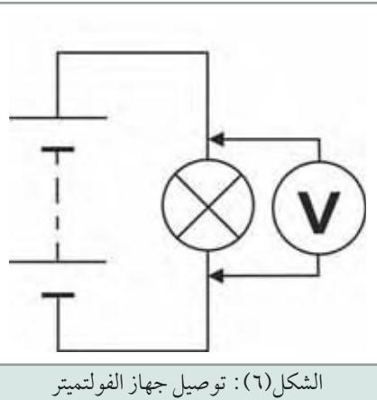
الشكل (٦): توصيل جهاز الفولتميتر
