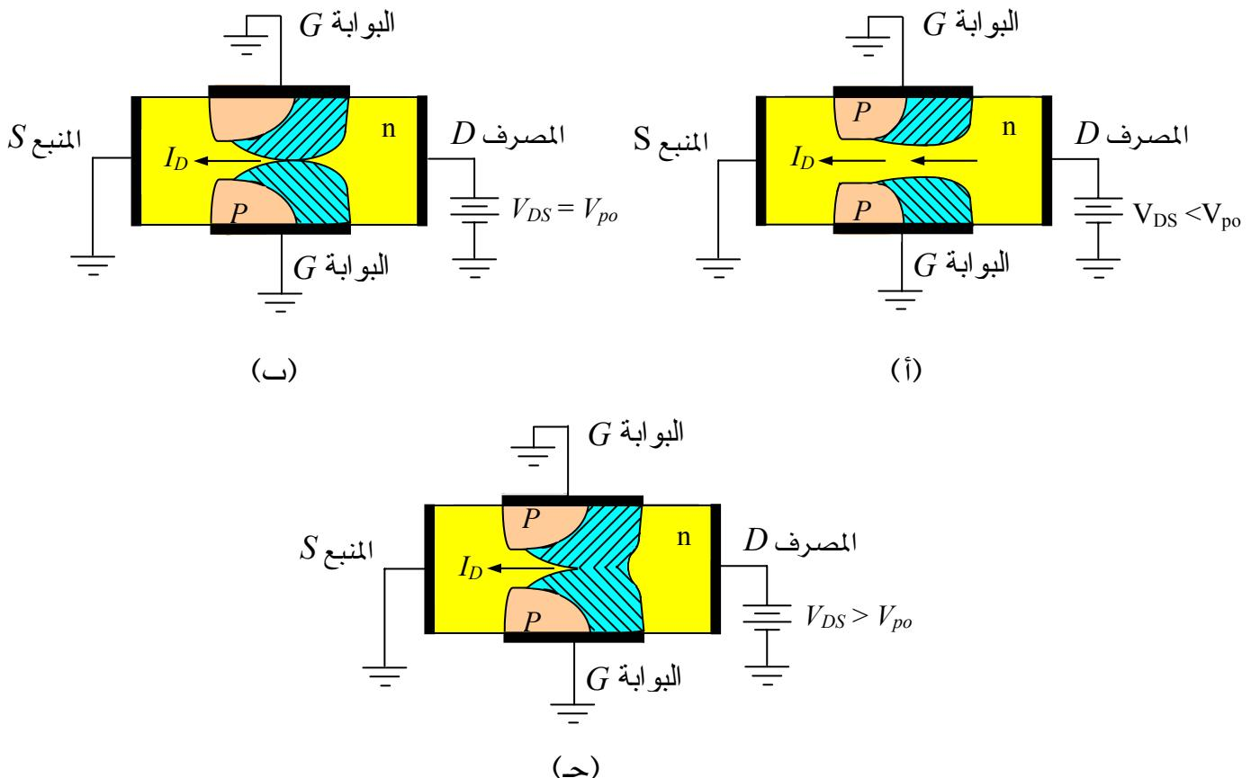
شكل (٧-٤) عرض منطقة الاستنزاف عند  $V_{GS} = 0$  وعن قيم مختلفة للجهد  $V_{DS}$ .
