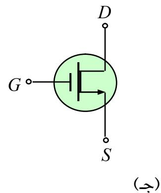
شكل (٧-١١) الرمز الإلكتروني لترانزستور MOSFET ذو القناة -n-. الرموز في (أ) و (ب) يمكن استخدامها للنوع التعزيزي أو النوع الافراغي، بينما يستخدم الرمز في (ج) للنوع الافراغي والرمز في (د) للنوع التعزيزي.
