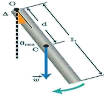
يُعطى دور النواس الثقلي بالعلاقة:  $T_0 = 2\pi \sqrt{\frac{I_{\Delta}}{mgd}}$
