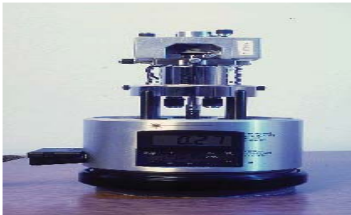
شكل رقم (٢-٢٣) المجهر النفقي الماسح (STM) (٢٤).
