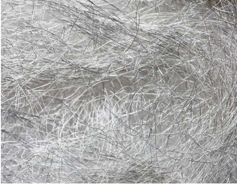
شكل رقم (٢-١٥) صورة ميكروسكوبية لأسلاك نانوية مصنوعة من السليكون (٩٢).
