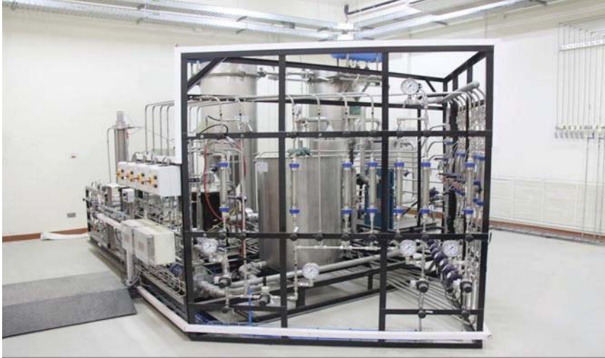
شكل رقم (٥-٤) محطة تجريبية لإنتاج مسحوق نانوي (٩٤).
