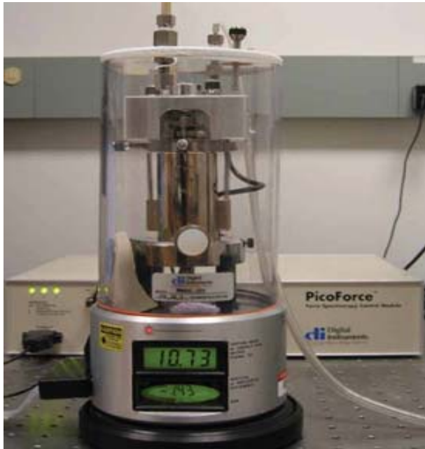
شكل رقم (٢-٢٧) مجهر القوة الذرية (AFM) (٣٢).
