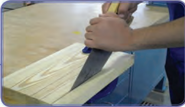
الشكل (٢) عملية شق طولي للألياف.
