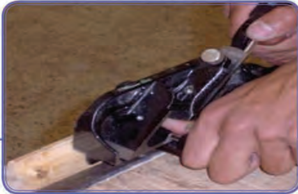
الشكل: (٢) قطعة خشب تم تسويتها بفارة الفرز.
