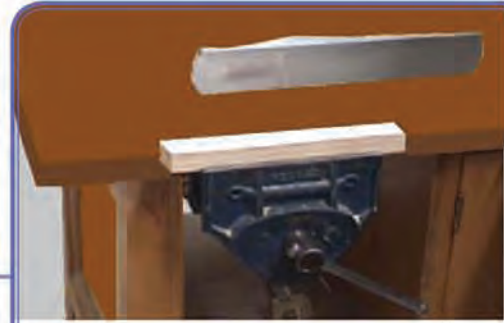
الشكل: (١) قطعة خشب تم مسحها بالفارة العادية.
