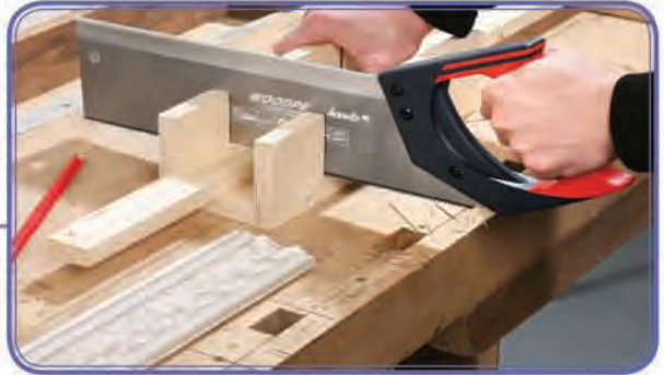
الشكل (١) عملية قطع عرضي للألياف.
