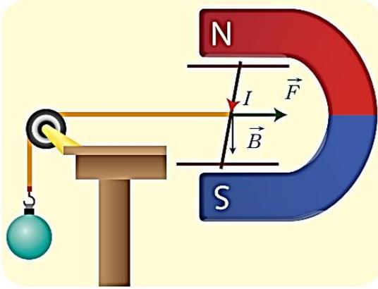
في الشكل المجاور تستند ساق نحاسية طولها 10 cm، وكتلتها 20 g على سكتين نحاسيتين أفقيتين، وتخضع بكاملها لحقل مغناطيسي منتظم شاقولي شدته  $B = 2 \times 10^{-2} \text{ T}$  ويمرُّ بها تيار كهربائي متواصل شدته 15 A وللحفاظ على توازن هذه الساق نعلق في مركز ثقلها خيطاً لا يمتد كتلته مهملة، مربوطاً بكتلة، المطلوب:
