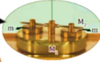
تتألف ميقاتية من قرص نحاسي كتلته  $M_1 = 0.12 \text{ kg}$  نصف قطره  $R = 0.05 \text{ m}$  مثبت عليه ساق كتلتها  $M_2 = 0.012 \text{ kg}$  طولها  $L = 0.1 \text{ m}$  تحمل في طرفيها كتلتين نعدهما نقطيتين  $m_1 = m_2 = 0.05 \text{ kg}$  كتلتان تبعدان عن بعضهما البعض مسافة قدرها  $2r = 0.04 \text{ m}$  يمكن تغييرها بوساطة بزّال، نعلق جملة القرص وما عليه من مركز عطالتها إلى سلك فتل شاقولي ثابت فتله  $k = 8 \times 10^{-4} \text{ m.N.rad}^{-1}$  كما في الشكل المجاور.
