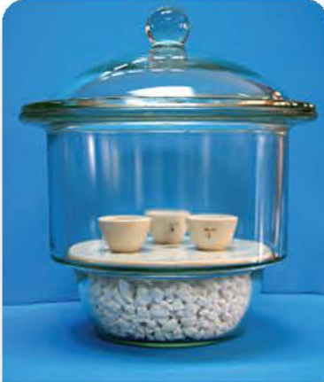
الشكل 18-5 يجفف كلوريد الكالسيوم الهواء من جزيئات الماء. كما يستعمل في المختبر في حفظ المواد الكيميائية من رطوبة انجو.
