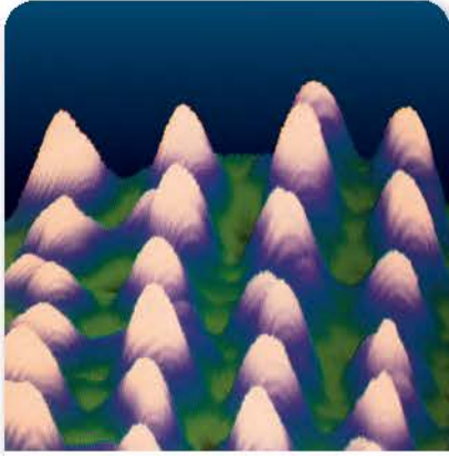
الشكل 3-5 هذه الصورة أخذت بجهاز STM، وهي تبين ذرات منفردة في حمض دهني على سطح من الجرافيت. وقد تم إضافة بعض الألوان للصورة لتوضيح صورة الذرات.
