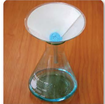
الشكل 13-2 عندما يمر المخلوط عبر ورقة الترشيح تبقى المادة الصلبة في الورقة، في حين يتجمع السائل المتبقي في الكأس.
