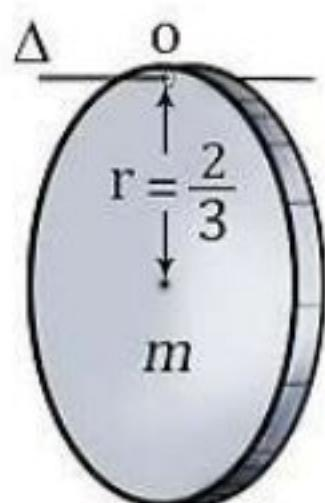
$$\text{الحل: (1)} \quad \text{علاقة الدور للنواس الثقلی المركب هي: } T_0 = 2\pi \sqrt{\frac{I_\Delta}{mgd}}$$
