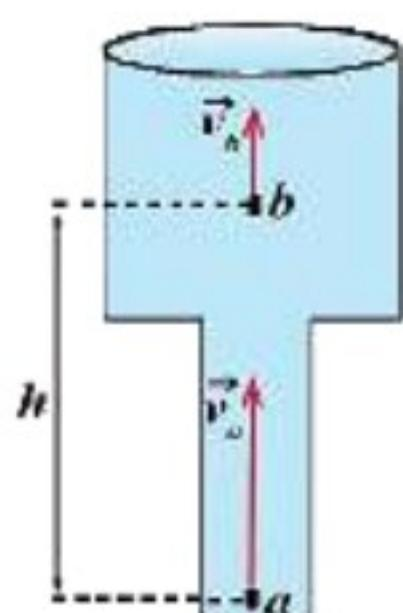
$$s_1 v_1 = s_2 v_2$$
