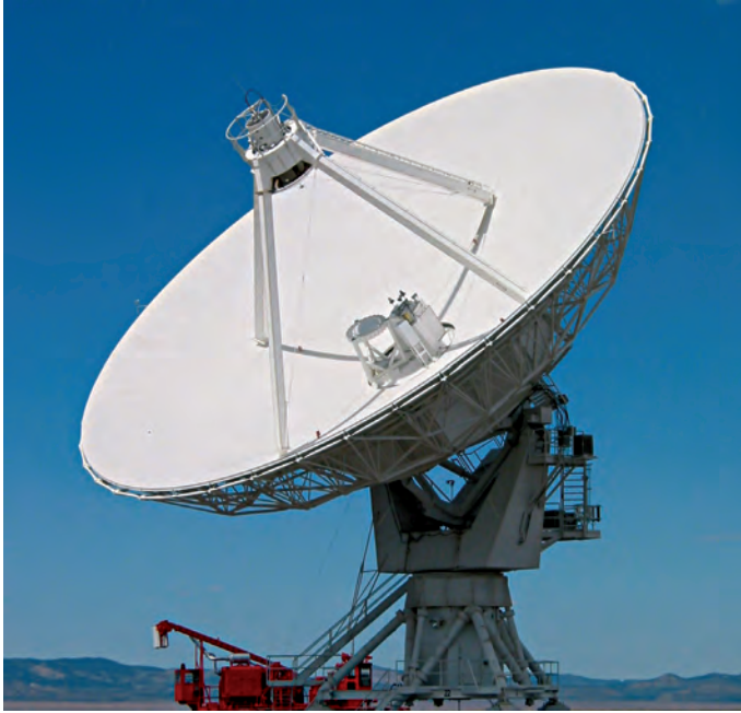
الشكل ٢٠ يُستخدم المنظار الفلكي الراديوي لدراسة موجات الراديو المنتقلة عبر الفضاء.
