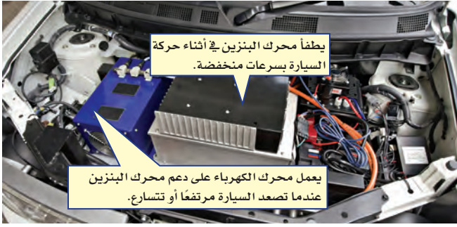
الشكل ٧ السيارات المعتمدة على البنزين والكهرباء - كالتى في الشكل - تقلل من استخدام البنزين؛ فهي تحتوي على محركين: أحدهما يعمل بالبنزين، والآخر بالكهرباء.
