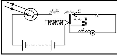
٢) عندما يعترض شخص طريقة الأشعة ينعدم تيار الخلية فيفقد المغناطيس مغنطته ويرتد الساق المعدني وتصبح دائرة الجرس مغلقة فيمر تيار كهربائي ويصدر صوت الجرس.
