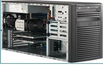
تُعرف وحدة النظام أيضاً بصندوق النظام، وهي حاوية تضم معظم المكونات الإلكترونية التي تشكل نظام الحاسب الآلي. ولها ثلاثة مكونات مهمة هي: اللوحة الأم، ووحدة المعالجة المركزية (CPU)، والذاكرة.
