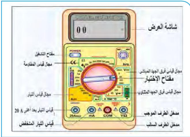
الشكل (١- ٢٢): جهاز قياس من النوع الرقمي.
