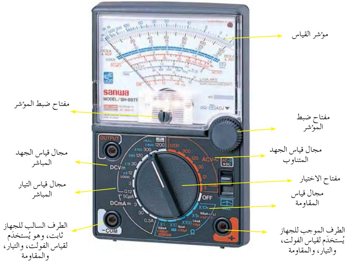
الشكل (١٧-١): جهاز القياس مُتعدد الأغراض الأفوميتر.
