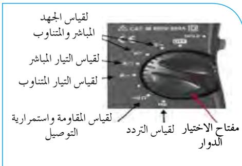
الشكل (٢٨-١): مفتاح الاختيار الدوار لجهاز الكلامبيتر.
