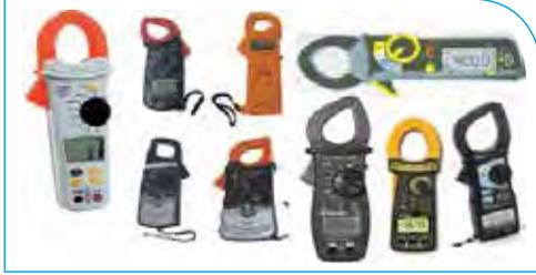
يُستخدم هذا الجهاز لقياس التيار الكهربائي، وتشخيص الشكل (١-٢٥): أشكال متعددة لجهاز الكلامبيتر. الأعطال بطريقة آمنة وسريعة وغير مكلفة، من دون حاجة إلى فصل الدارة أو قطعها، وبطريقة التأثير المغناطيسي. والشكل (١-٢٥) يبين أشكالاً مُتعددة من جهاز الكلامبيتر.
