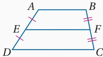
$$\overline{EF} \parallel \overline{AB} \parallel \overline{DC}$$
