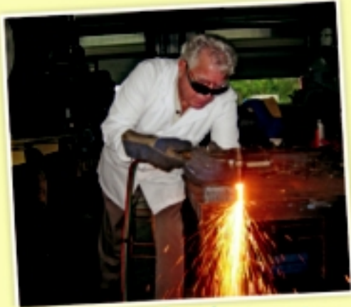
يستخدم الأكسجين مختلطاً مع الأستيلين في لحام المعادن.
