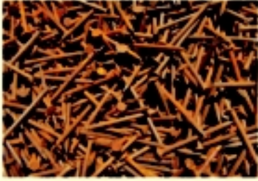
شكل (٣-١١): المسامير يعلوها الصدأ إثر تعرضها للرطوبة.
