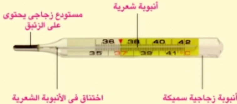
شكل (٢-٨): تركيب الترمومتر الطبي.
