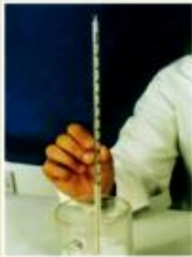
شكل (٢-١٢): قياس درجة حرارة السوائل باستخدام الترمومتر المئوي.
