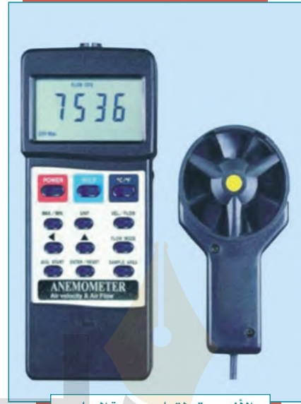
الأنيمومتر لقياس سرعة الرياح
