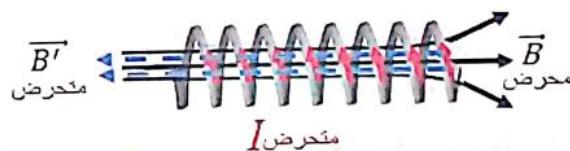
بما أن الحقل المغناطيسي  $\vec{B}$  المحرض يتزايد، فإن التدفق المغناطيسي المحرض  $\Phi$  يتزايد، وحسب قانون لenz فإن جهة الحقل المغناطيسي  $\vec{B}'$  المترعرض بعكس جهة الحقل المغناطيسي  $\vec{B}$  المحرض ليعاكس تزايد التدفق المغناطيسي المحرض.
