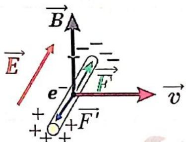
إن تراكم الشحنات الكهربائية على طرف الساق يولد حفلاً كهربائياً داخلياً  $\bar{E}$  يتوجه من الطرف الذي يحمل شحنات كهربائية موجبة إلى الطرف الذي يحمل شحنات كهربائية سالبة يؤثر هذا الحقل الكهربائي في الإلكترون الحر بقوة كهربائية  $\bar{F}'$  جهتها تعاكس جهة القوة المغناطيسية  $\bar{F}$  (قوة لورنزي) المؤثرة في هذا الإلكترون تزداد شدة الحقل الكهربائي بازدياد تراكم الشحنات الكهربائية مما يزيد من شدة هذه القوة الكهربائية لتصبح متساوية لشدة القوة المغناطيسية (قوة لورنزي) فتوقف حركة انتقال الإلكترونات.
