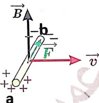
عند تحريك الساق بسرعة ثابتة  $v$  ضمن حقل مغناطيسي منتظم  $B$  بحيث:  $B \perp v$  فإن الإلكترونات الحرة في الساق ومع خصوصيتها لهذا الحقل تتأثر بقوة لورنزي:
