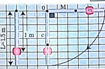
$$T_0 = 2\pi \sqrt{\frac{I_{\Delta}}{(m' + M) g d}} \quad \dots\dots (1)$$
