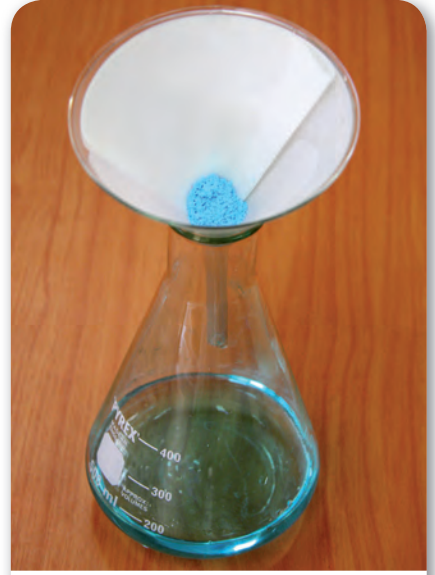
الشكل 13-2 عندما يمر المخلوط عبر ورقة الترشيح تبقى المادة الصلبة في الورقة، في حين يتجمع السائل المتبقي في الكأس.
